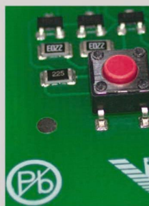
Micro Switch bien brasé avec un bon profil de refusion
